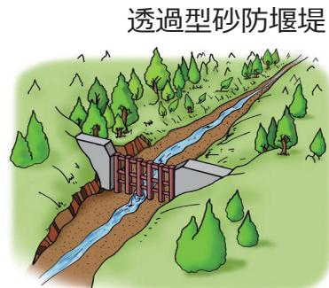
透過型砂防堰堤を設けた場合でも、普段は、水と土砂は同じように下流に流れていきます。
