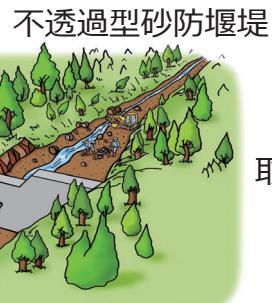
不透過型砂防堰堤を設けると、堰堤の上流側に土砂が少しずつたまっていきます。土砂をためる量を確保するため、取り除くこともあります。
