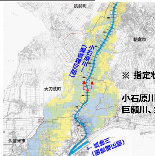
〈参考〉筑後川水系小石原川 洪水浸水想定区域図 （※計画の基本となる降雨による浸水想定区域図）
