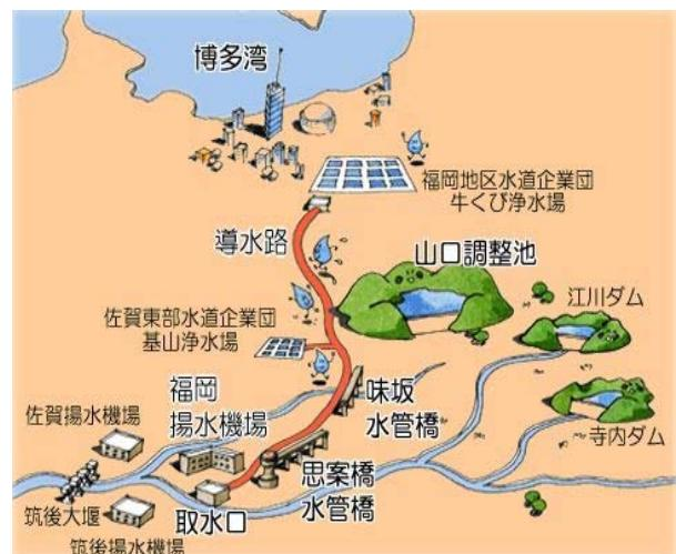
福岡導水は筑後大堰湛水区域より取水し、延長約25kmの導水路及び調整池により牛ぐび浄水場まで導水する他、導水路の途中より佐賀東部水道企業団の基山町分を分水しています。
