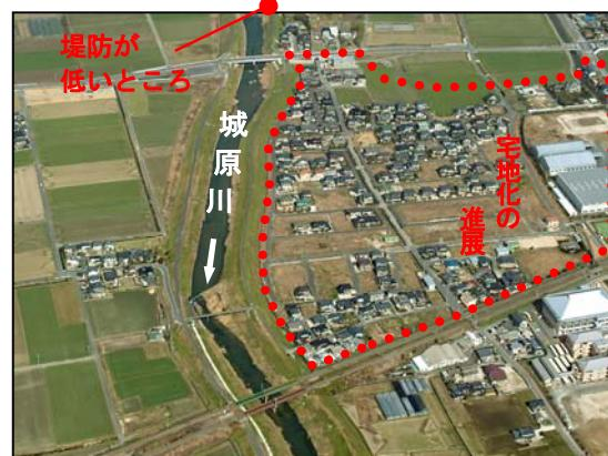
写真 1－2－30 城原川の堤防と周辺の宅地化
