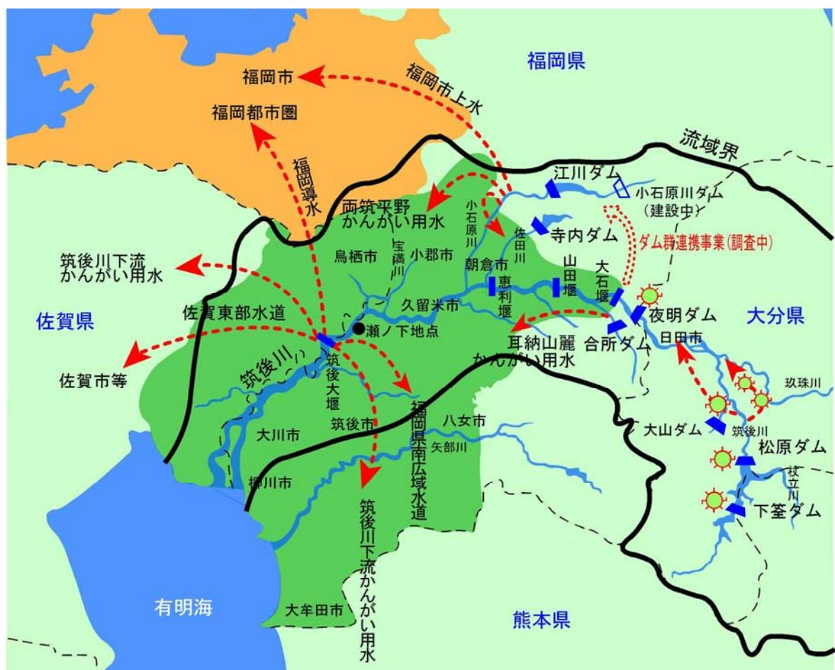
図2-2-1 筑後川の水利用模式図
