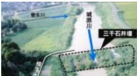
城原川以西地域の水量不足を補うため、三千石堰で水を堰上げ取水し、横落水路によりかんがいを行っています。
