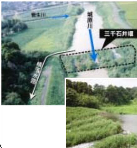
城原川以西地域の水量不足を補うため、三千石堰で水を堰上げ取水し、横落水路によりかんがいを行っています。
