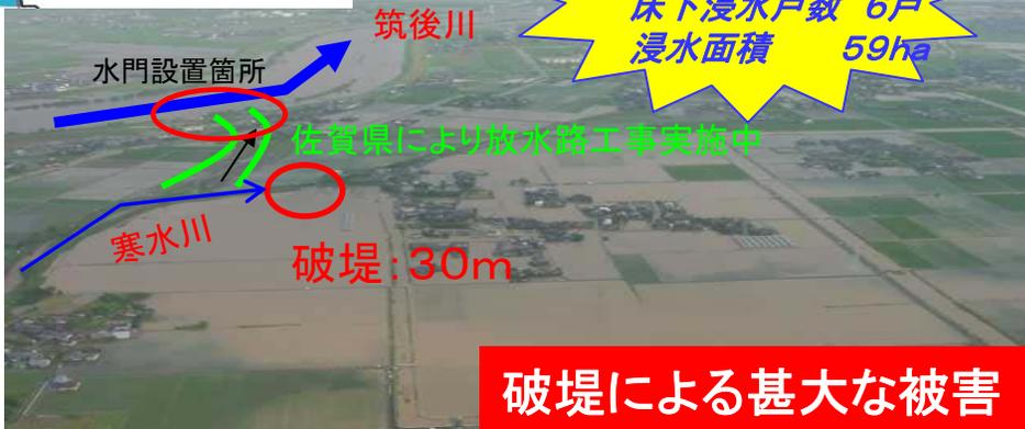
破堤による甚大な被害
