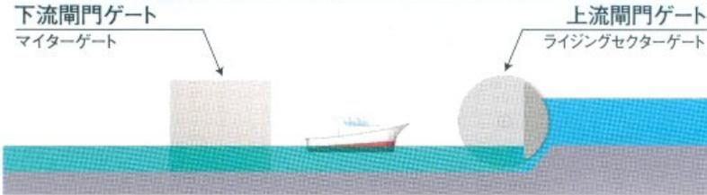
下流閘門ゲート(マイターゲート)を開いた状態、上流閘門ゲート(ライジングセクターゲート)を立て起こした状態で、船が閘門の中に入航し待機します。
