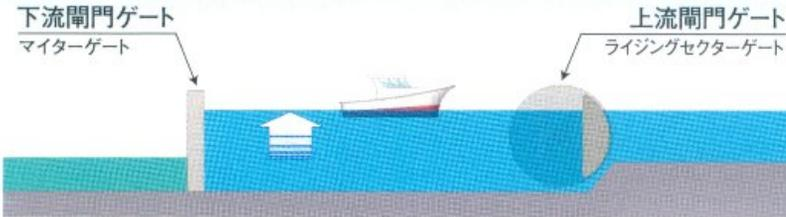
下流閘門ゲートを閉じて閘門を充水し、閘門と上流側の水面の高さを合わせます。(閘門の水面の高さを上げます)
