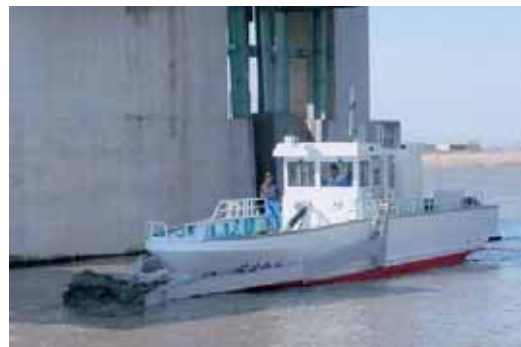
写真 4-3-8 ガタ土を除去するガタ土除去船
