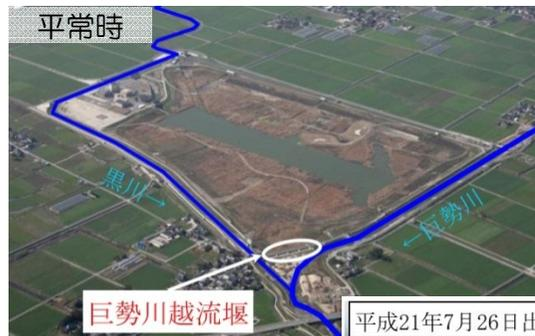
平成21年7月洪水では、巨勢川調整池（最大貯水量220万m<sup>3</sup>）に約190万m<sup>3</sup>を貯水し、下流域の浸水被害軽減に寄与。また、整備された8つのポンプは幾度と無く可動し、内水被害を軽減。
