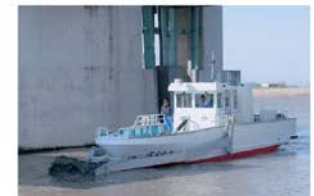
写真4-3-8 ガタ土を除去するガタ土除去船
