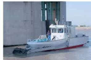
写真4-3-8 ガタ土を除去するガタ土除去船
