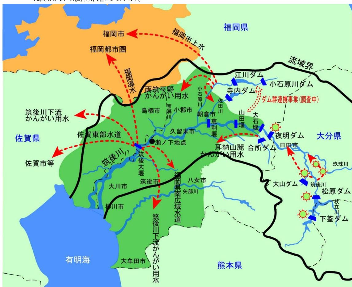
図 2-2-1 筑後川の水利用模式図
