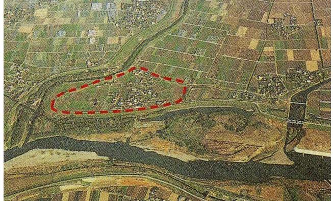
写真1－2－32 佐田川合流点の輪中堤(大刀洗町)
