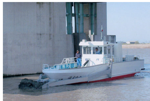
写真 4-3-8 ガタ土を除去するガタ土除去船
