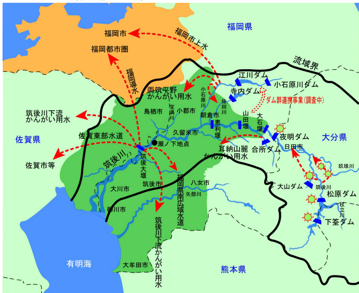
図2-2-1 筑後川の水利用模式図
