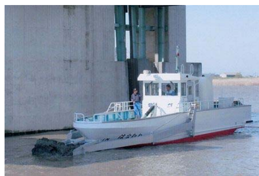
写真4-3-8 ガタ土を除去するガタ土除去船
