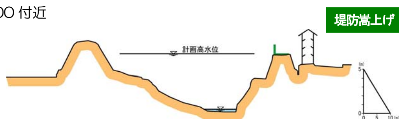
図 4-2-8 代表横断面図 (右岸：千代田町崎村)
