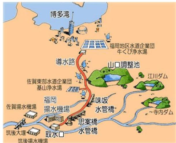
福岡導水は筑後大堰湛水区域より取水し、延長約25kmの導水路及び調整池により牛くび浄水場まで導水する他、導水路の途中より佐賀東部水道企業団の基山町分を分水しています。
