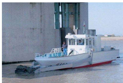
写真 4-3-8 ガタ土を除去するガタ土除去船
