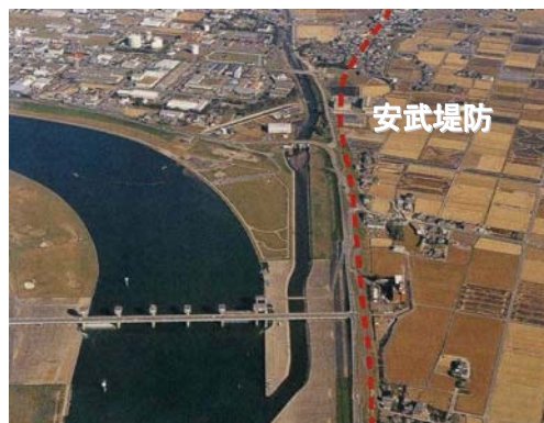
写真1-2-8 安武堤防（久留米市安武町） 対岸の佐賀藩が長大な千栗堤を築いたため、洪水から久留米藩の領地を守るために築られました。
