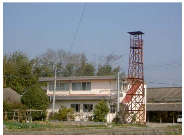
写真 4-3-11 情報伝達のための半鐘 昔は、火災や洪水を知らせる手段として、半鐘等が利用されていましたが、最近では少なくなっています。
