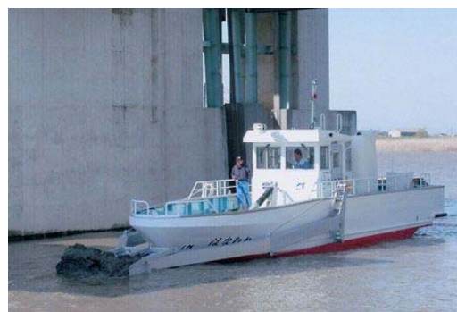
写真 4-3-8 ガタ土を除去するガタ土除去船
