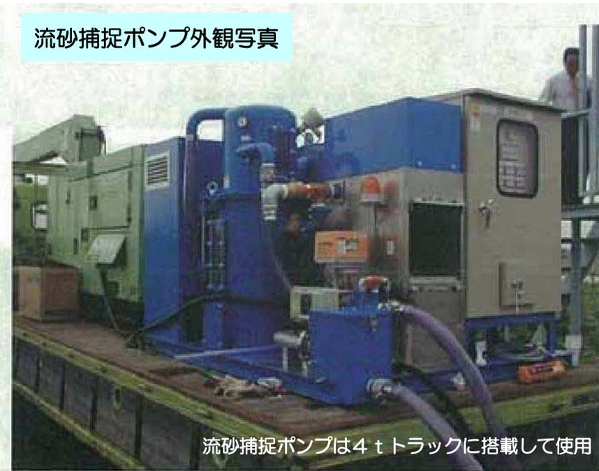
流砂捕捉ポンプは4 tトラックに搭載して使用
