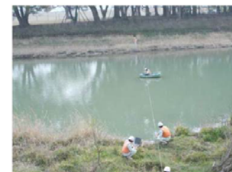
写真 5.2.1 河道の横断測量
