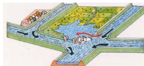
③大きな洪水の時は、洪水の一部を越流堤から計画的に遊水地に導き、一時的に貯留し、河川の流量を低減させる
