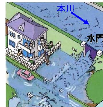
本川の堤防が支川の堤防より高い場合、本川の逆流を防ぐために水門・樋門を設置。
