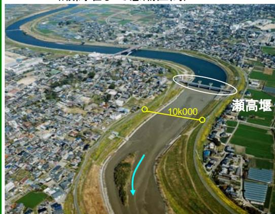
■洪水のせき上げの要因となっていた固定堰を可動堰に改築(流下能力向上)
