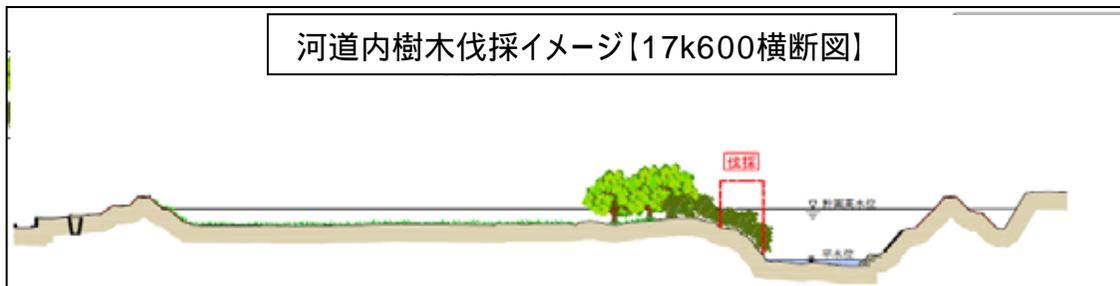
樹木伐採箇所として南筑橋より上流側に連なる樹木繁茂箇所の川岸の一部伐採を掲げています。当該箇所は樹木繁茂により洪水時に流下断面が不足することから、伐採の必要があると考えているところです。**伐採に際しては、動植物への影響も考えられ、必要最小限の伐採**となるよう伐採方法も含め、学識経験者からの意見を聴くなど対応することとします。
