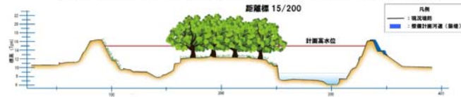
図 5.2.4 堤防整備の概要図(矢部川左岸 15/200 付近)
