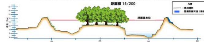
図 5.2.3 堤防整備の概要図(矢部川右岸 15/200 付近)
