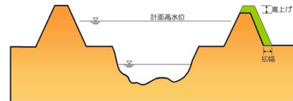
図 5.2.1 堤防の嵩上げ・拡幅の概要図
