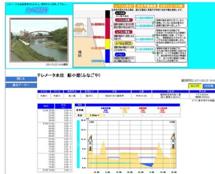
図 5.3.9 筑後川河川事務所ホームページにて確認できる河川情報（筑後市船小屋地点での「カメラ画像」や「水位情報」の閲覧データ）
