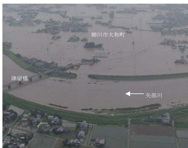
写真 1.2.14 堤防の決壊状況（矢部川右岸 7/300）
