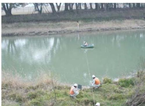
写真 5.2.1 河道の横断測量
