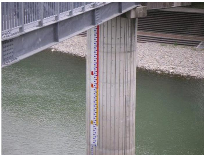
写真 5.3.6 川の水位情報（危険度レベル）を印として現地に設置した例
