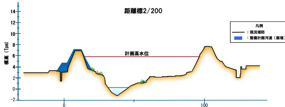
図 5.2.5 堤防整備の概要図(飯江川左岸 2/200 付近)
