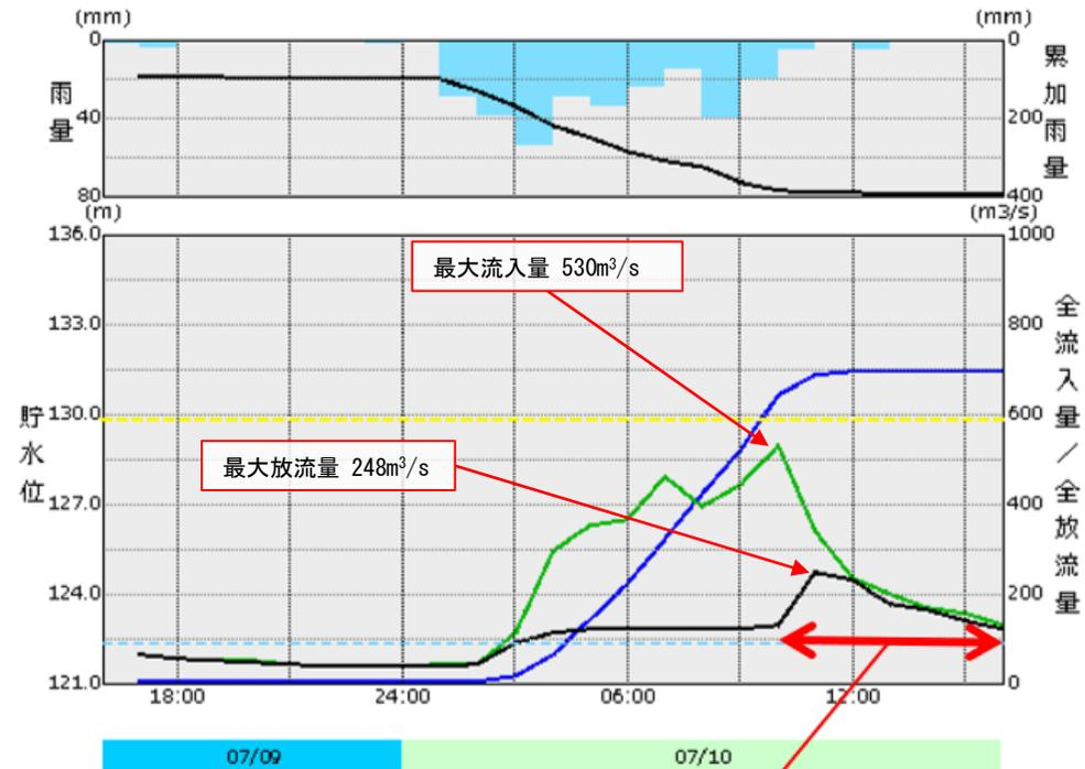
洪水時にはダムに流れ込む水量の一部を貯め、ピーク時に下流へ流す水量を約2割低減 (放流量約81m³/sカット)
