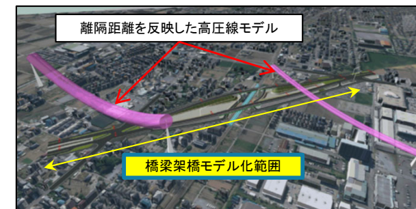
橋梁と架空線の離隔確認
