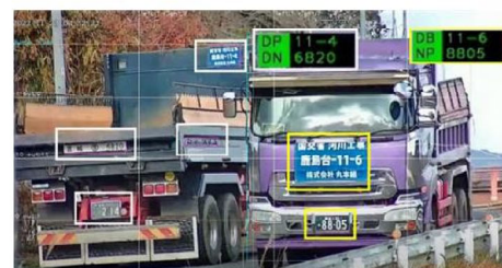
AIカメラによるダンプのリアルタイム入退管理
