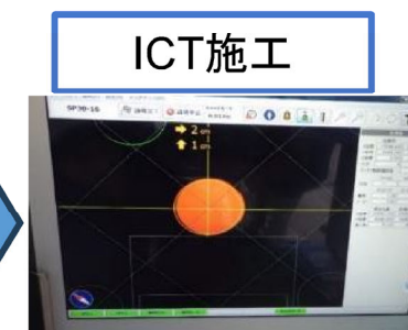
ICT施工 ・GNSSによる 杭芯位置ナビゲーション ・杭芯位置の全数座標記録 による杭間隔計測の省略
