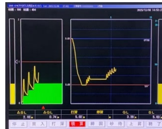
計測データを用いた砂投入量の管理
