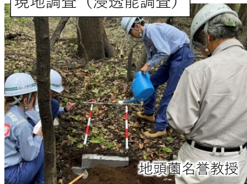
現地調査（浸透能調査）
