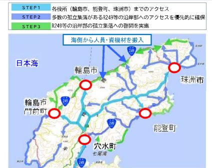
令和6年能登半島地震における道路啓開
