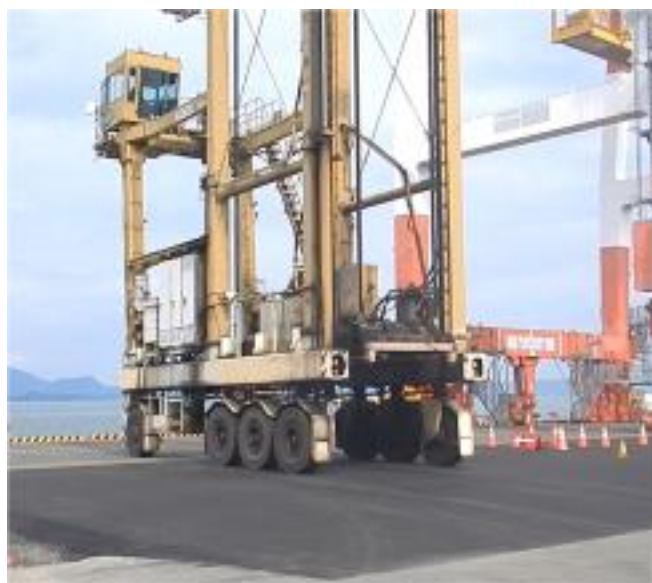
応急復旧で設置したスロープを走行するストラドルキャリア
