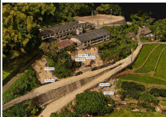
▲宇城市TEC被災調査成果 (ドローンによる点群データ)
