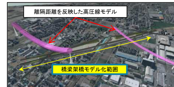
橋梁と架空線の離隔確認
