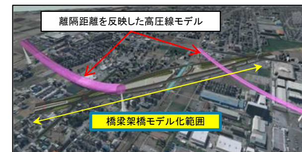
橋梁と架空線の離隔確認
