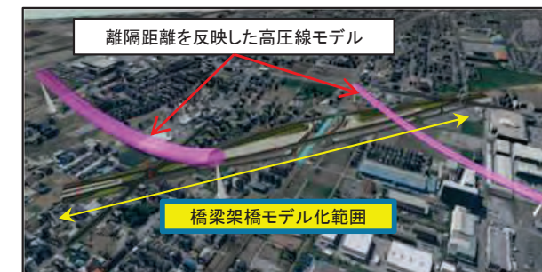
橋梁と架空線の離隔確認
