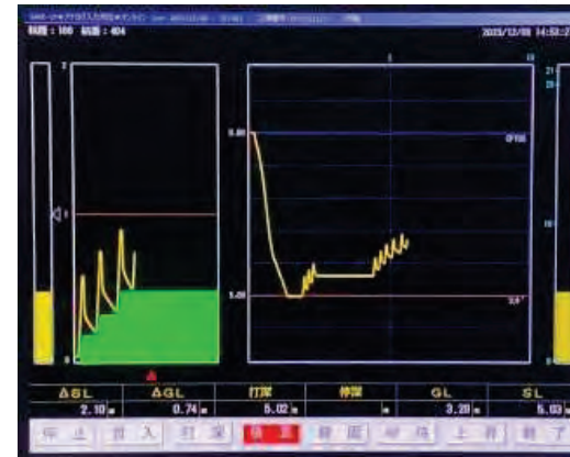
計測データを用いた砂投入量の管理
