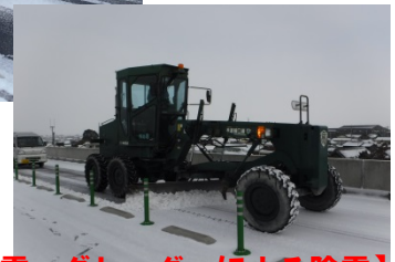
【塩カル散布による融雪、グレーダーによる除雪】
