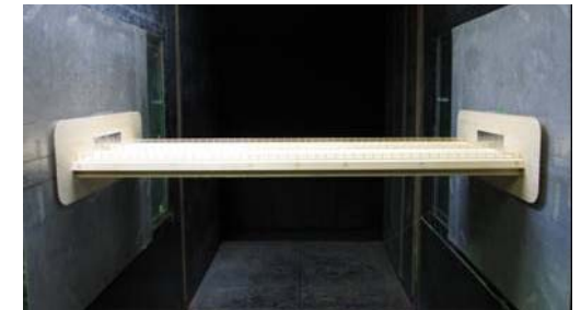
風洞試験（部分模型）
