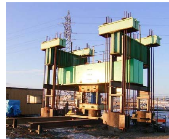
杭の載荷試験事例
