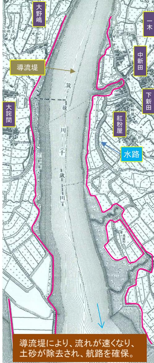
導流堤により、流れが速くなり、土砂が除去され、航路を確保。
