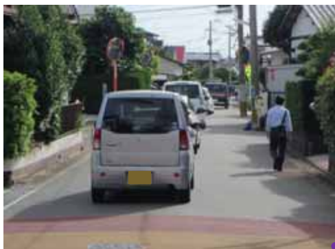
歩車区分がない生活道路に、連担して走行する通過交通
