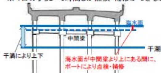
海水面に最も近接している箇所(大井埠頭橋付近) ※1日のうち2~3時間しか点検・補修ができない
