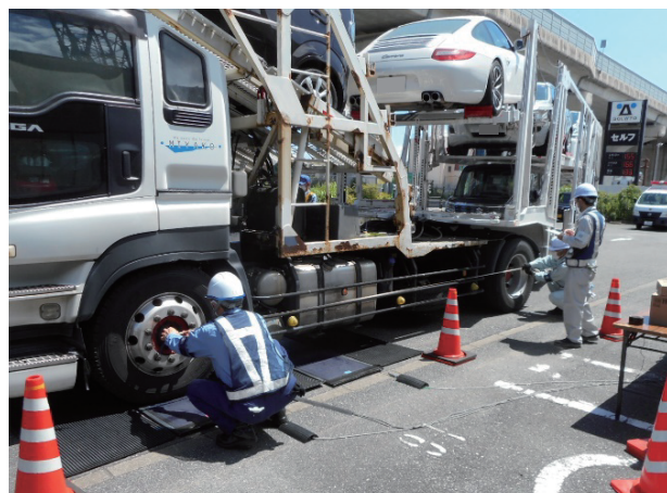
▲車両の長さを計測
