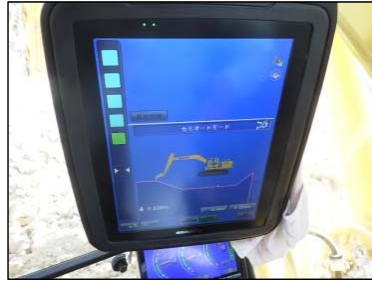
3DMCバックホーによるリッパー掘削(軟岩) モニター確認
