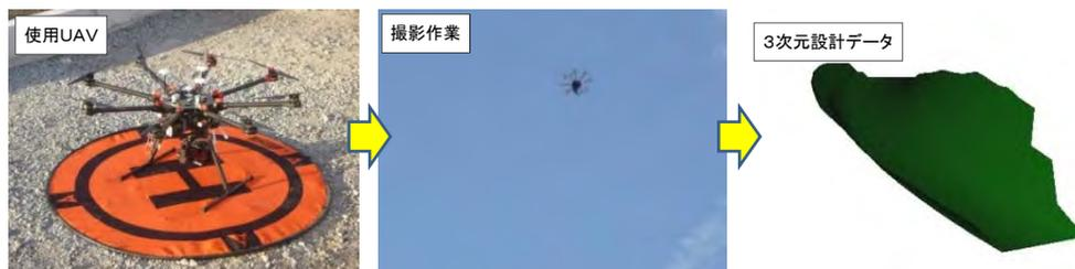
UAVを用いて写真測量を行い、点群データ及び3次元設計データを作成。
