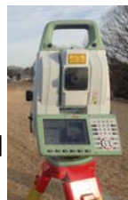
例) 1秒精度で計測 できるTS (Leica MS60)
