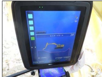
3DMCバックホーによるリッパ掘削(軟岩) モニター確認
