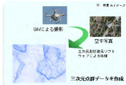
UAVを用いた空中写真による三次元点群測量
