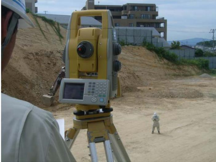
横断観測時、ミラー位置の横断線に対する前後のズレを表示しますので正確に横断線上の位置を観測出来ます
