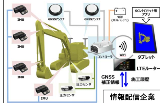
出展 コマツ・LANDLOG 「SCレトロフィット」
