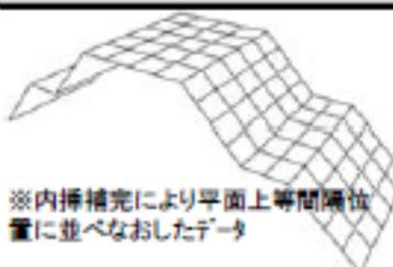
※内挿補完により平面上等間隔位置に並べなおしたデータ
