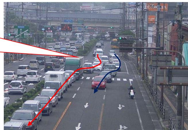
交差点内に残った右折車両により交差点道路交通や横断歩行者を視認しにくいため**接触事故が発生**している
