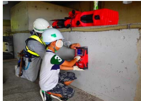
【橋台の鉄筋探査体験】
